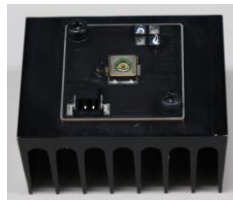
写真9 フィン下向き (空気の流れを妨げた向き)
